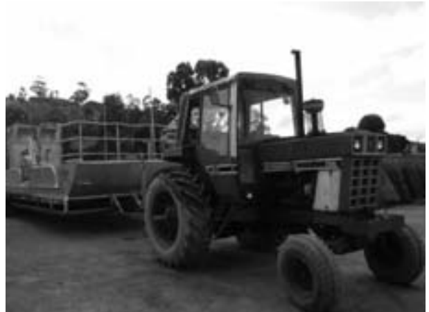
写真 5 : 車台に乗った状態の作業船。トラクターで水辺まで引いて行く。Tasmanian Clean Water Oysters 社の敷地内
